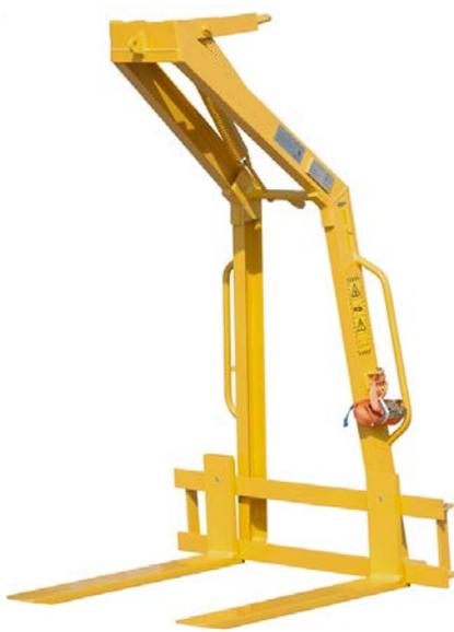
Вилочный захват для башенных кранов
